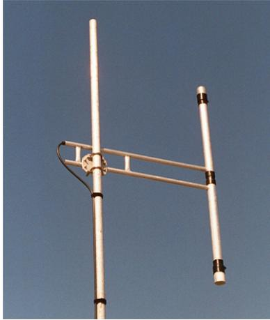
Antena omnidireccional de polarización vertical.
