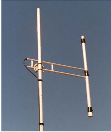
Dipolo en proceso de medición
