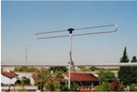
Dipolo en proceso de medición
